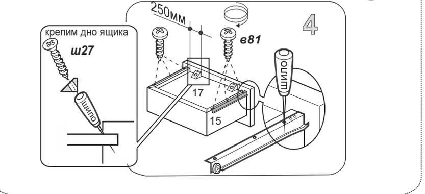
Установив верхний щит (01), вставив ящики и выровняв корпус (он может быть ромбовидный) прибиваем задние стенки.
